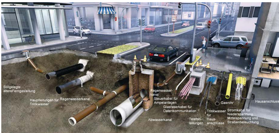
Bild 1 Versorgungsleitungen in der Straße (Quelle: E.ON)
