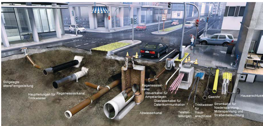
Bild 1 Versorgungsleitungen in der Straße (Quelle: E.ON)
